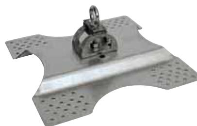
Il punto d'ancoraggio LDV055K è stato studiato e prodotto per strutture fragili, a completamento della linea vita in classe C Securope®. In caso di caduta la parte superiore dell'ancoraggio si abbatte riducendo gli sforzi trasmessi alla struttura.
