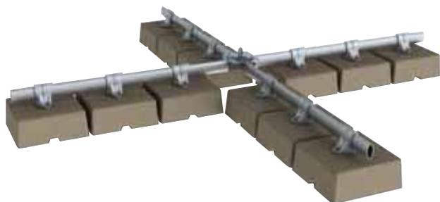
Punto d'ancoraggio che assicura una protezione individuale temporanea su coperture piane o con un'inclinazione massima di 5°. Geometria a croce con zavorra in CLS da 300 kg composta da blocchi da 25 kg l'uno collegati al telaio tramite viti e rivetti e dotati di una guaina in neoprene che salvaguarda l'integrità del manto di copertura.
