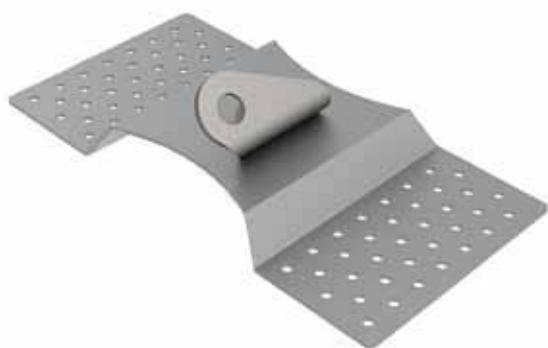
Punto di deviazione caduta composto da una piastrina mono-ancoraggio e un'apposita piastra studiata per il fissaggio su coperture in lamiera. LDV036 è utilizzabile solo come punto di deviazione caduta, per evitare l'effetto pendolo.
