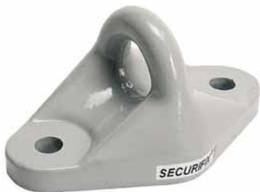
Bi-ancoraggio in alluminio per la protezione individuale permanente di un operatore per lavori su coperture e facciate oppure utilizzabile come punto d'accesso all'area di lavoro. Il punto d'ancoraggio è una fusione d'alluminio verniciata e personalizzabile al RAL desiderato.
