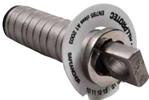
Punto d'ancoraggio a scomparsa fissato in modo permanente al manufatto e progettato per le applicazioni strutturali su superfici verticali, orizzontali o inclinate, come muri, colonne, pavimenti e architravi. Quando non è in uso il punto d'ancoraggio scompare nella bussola; per aprirlo è sufficiente una leggera pressione sul golfare.
