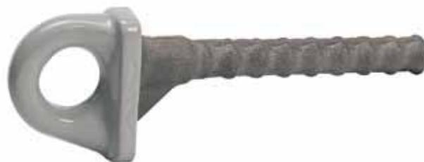
Mono-ancoraggio in acciaio inossidabile composto da una barra di fissaggio diam. 16mm unita ad un anello d'ancoraggio tramite una staffa antirotazione; l'anello e la staffa sono verniciati e personalizzabili al RAL desiderato.
