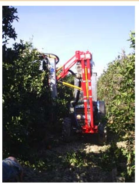
Foto 5.5 – Barra falciante per potatura meccanica
