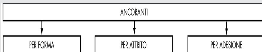
Negli ancoranti funzionanti per forma la forza resistente è generata dal bloccaggio geometrico tra il foro e l'ancorante stesso, il foro viene eseguito con una punta particolare per consentire l'apertura del meccanismo di bloccaggio.
