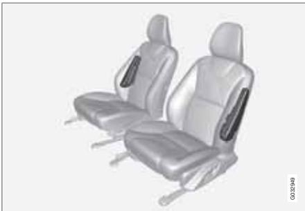
In caso di collisione laterale, la maggior parte della forza di collisione viene distribuita dal SIPS (Side Impact Protection System) alle traverse, ai montanti, al pavimento, al tetto e ad altre parti della carrozzeria. Gli airbag laterali dei sedili del conducente e del passeggero proteggono busto e fianchi e costituiscono una parte importante del SIPS.
