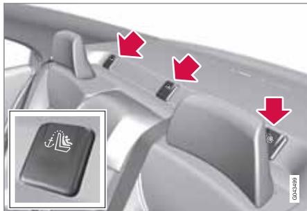
L'automobile è dotata di attacchi superiori per seggiolini per bambini. Questi attacchi, situati nel piano portaoggetti, sono nascosti da coperture di plastica. Spostare le coperture di plastica per accedere ai rispettivi attacchi.
