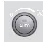
Ruotare la manopola per aumentare o ridurre la velocità della ventola. Selezionando **AUTO**, la velocità della ventola si regola automaticamente. La velocità della ventola impostata precedentemente si disattiva.
