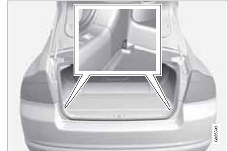
Gli occhielli fermacarico ripiegabili<sup>1</sup> si utilizzano per fissare le cinghie che mantengono fermi gli oggetti nel bagagliaio.
