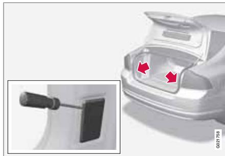
1. Inserire un cacciavite e fare leva leggermente per staccare l'alloggiamento lampadina.
