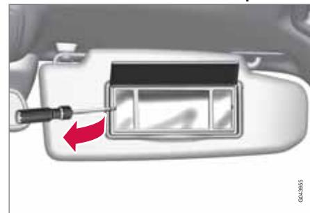
1. Inserire un cacciavite sotto la lente della lampadina e sollevare con cautela il fermo sul bordo.
