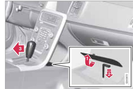
Se non è possibile guidare l'automobile, ad esempio perché la batteria di avviamento è scarica, occorre deselectionare la posizione **P** della leva selettore per spostare l'automobile.
