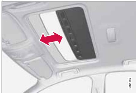
Una pressione prolungata del pulsante di bloccaggio chiude il tettuccio apribile e tutti i finestrini, vedere pagine 46 e 59. Le portiere e il baule si bloccano. Per interrompere la chiusura, premere nuovamente il pulsante di bloccaggio.
