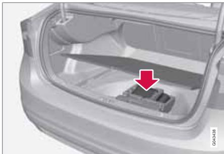
Sotto il tappetino del bagagliaio sono riposti l'occhiello di traino, il martinetto\* e la chiave per i dadi delle ruote\*. Qui è riposta anche la chiave per i dadi delle ruote antifurto.
