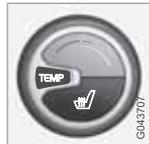
Premendo il pulsante una volta si ottiene il livello di riscaldamento max - 3 spie arancioni accese sullo schermo nel quadro centrale (figura sopra).
