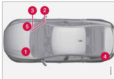
Posizione delle centraline elettroniche nelle automobili con guida a sinistra. Nelle automobili con guida a destra, le centraline sotto il cassetto portaoggetti sono invertite.
