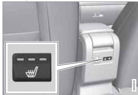
Premendo il pulsante una volta si ottiene il livello di riscaldamento max - 3 spie accese.
