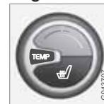
Il pomello permette di impostare la temperatura. Con l'ECC\*, la temperatura sui lati conducente e passeggero può essere impostata separatamente.
