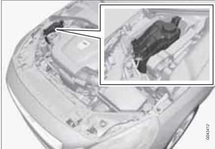
Per il rabbocco, seguire le istruzioni riportate sulla confezione. È importante dosare le quantità di refrigerante e acqua in base al clima. Non rabboccare mai soltanto con acqua. Il rischio di congelamento sussiste sia in caso di quantità insufficiente che eccessiva di refrigerante.
