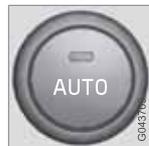
La funzione regola automaticamente temperatura, climatizzatore, velocità della ventola, ricircolo e distribuzione dell'aria.
