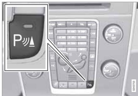
Il sistema si attiva automaticamente all'avviamento del motore - la spia dell'interruttore Off/On si illumina. Disattivando l'assistenza al parcheggio con il pulsante, la spia si spegne.
