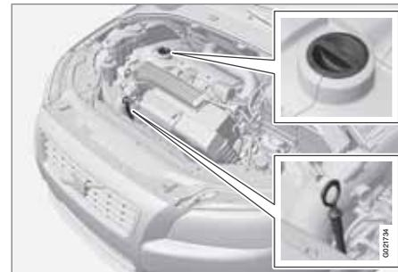
Asta di livello e tubo di rifornimento.
