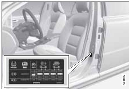
L'etichetta pressione pneumatici sul montante della portiera del conducente (tra portiera anteriore e posteriore) indica le pressioni dei pneumatici richieste in base al carico e alla velocità. Queste sono riportate anche nella tabella delle pressioni pneumatici, vedere pagina 394.
