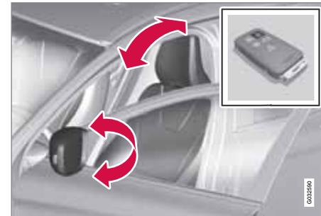
Tutte le chiavi telecomando possono essere utilizzate da diversi conducenti per memorizzare le regolazioni per il sedile del conducente
