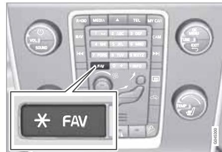
Il pulsante **FAV** permette di memorizzare le funzioni più utilizzate per attivarle facilmente premendo **FAV**. È possibile selezionare un'opzione preferita (ad esempio **Equalizzatore**) per ogni funzione come segue:
