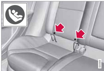
Gli attacchi per il sistema di fissaggio ISOFIX sono nascosti dietro la parte inferiore dello schienale del sedile posteriore, nei posti esterni.
