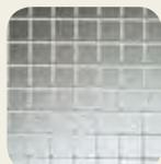
Particolare della rete zincata elettrosaldata da 40x40 mm (spess. Ø 3,5 mm).
