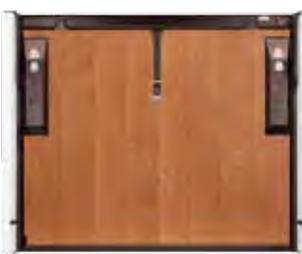
Vista interna porta basculante struttura Reserve Sikura HF con coibentazione e pannello interno in legno con trattamento completo di fondo impregnante tinta 2 (automazione ISY Ballan)
