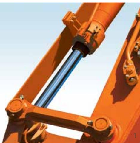
Protezione cilindro inclinata
