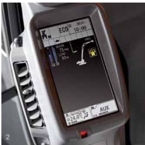
Allarme angolo di rotazione e sistema di allerta sovraccarico HRD
