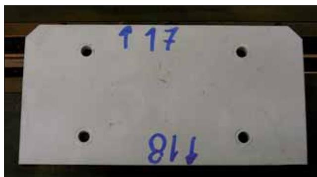
Figura 3 - Campione di saldatura tipico per la ricerca dei parametri di saldatura ottimali.
