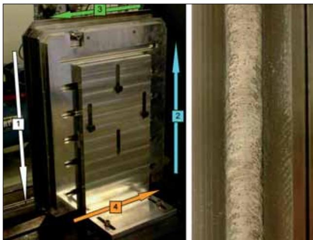
Figura 16 - Sequenza di saldatura delle cold plates; a destra il particolare dell'aspetto del cordone di saldatura.
