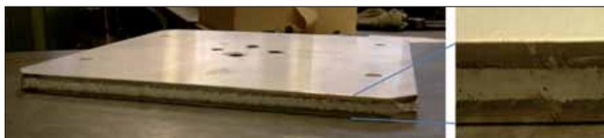
Figura 14 - Aspetto delle saldature del simulacro 200 x 200 AA 6082 T6.
