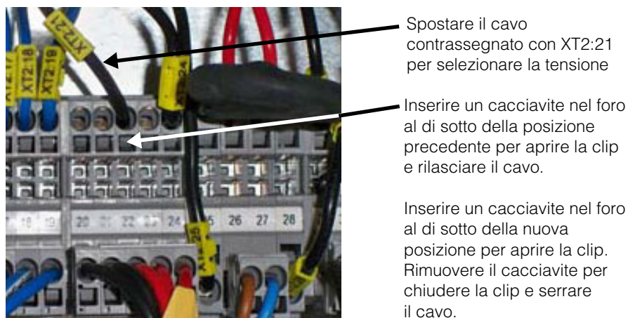
Figura 3-19 Spostamento del cavo dell'uscita in tensione (Conext serie Core XC originale)
