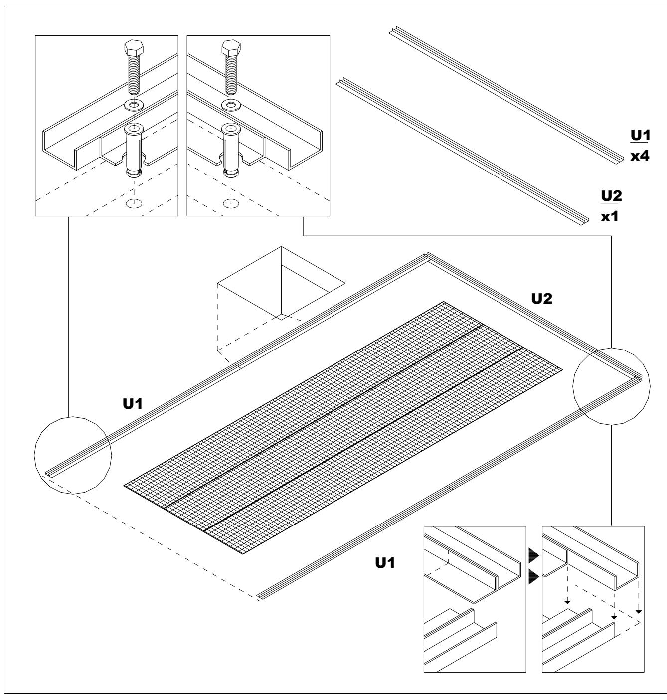
**I****BASAMENTO ED5 GB****BASEMENT ED5 F****SOUVASSEMENT ED5 D****UNTERBAU ED5**
