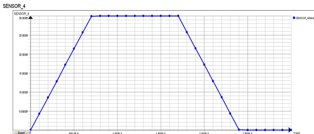
Fig. 3.8 Caratteristica della densità di corrente ( $A/m^2$ ) nel baricentro in funzione del tempo
