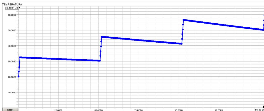
Fig. 3.19 Caratteristica della temperatura (°C) al baricentro del provino in funzione del tempo, impulso 1s, intervallo 5s, corrente 540A
