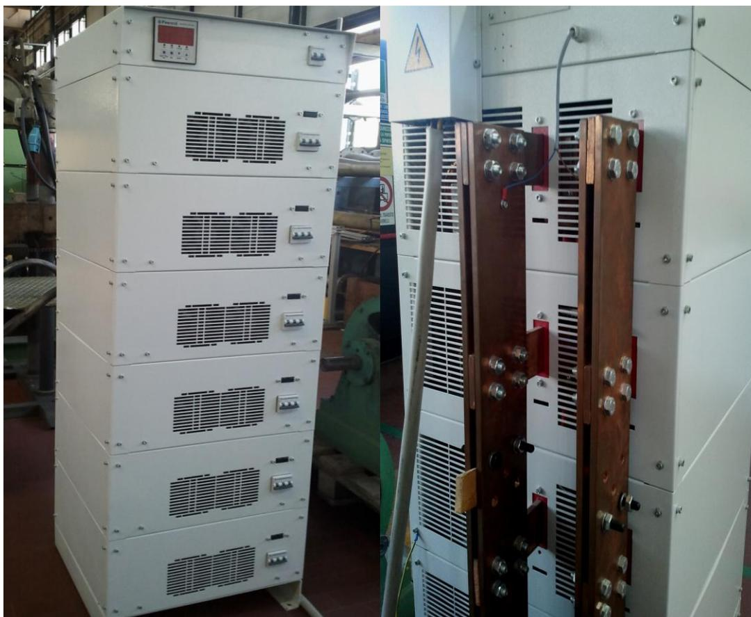
Fig. 3.6 Foto fronte e retro del Generatore di corrente Powerel Serie SM 600
