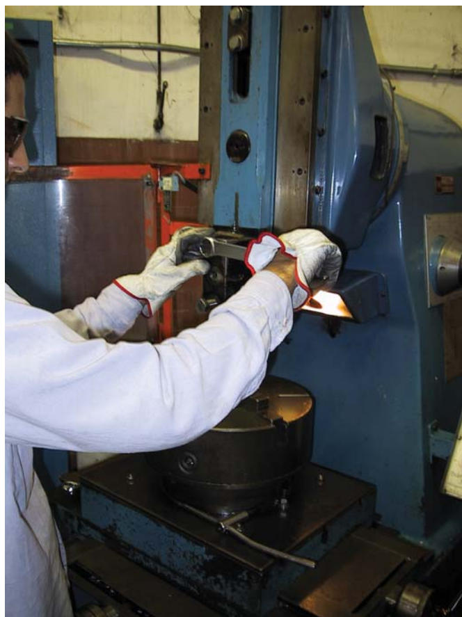
Figura 4 – Pezzo fissato sul piano di lavoro
