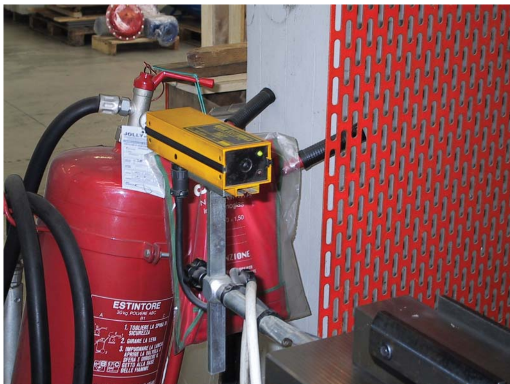
Figura 2 – Dispositivo di sicurezza a fotocellula
