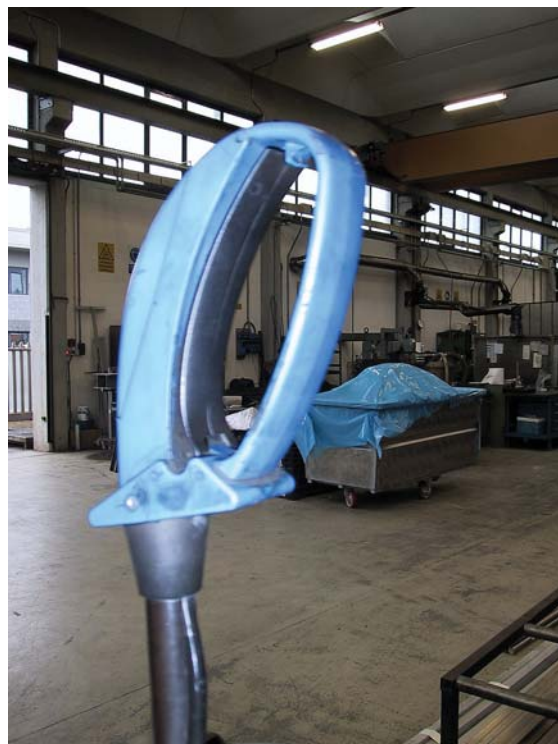
Figura 3 – Interruttore a pressione continua posto sull'impugnatura
