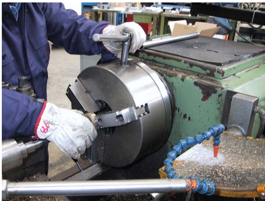
Figura 2 – Operazione di serraggio del pezzo
