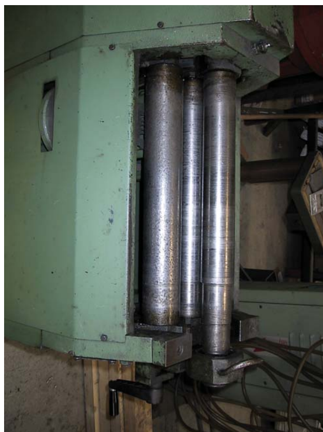
Figura 2 – Particolare dei rulli di calandratura
