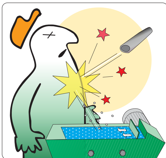
Proiezione del pezzo in lavorazione sull'addetto o nell'ambiente circostante.
