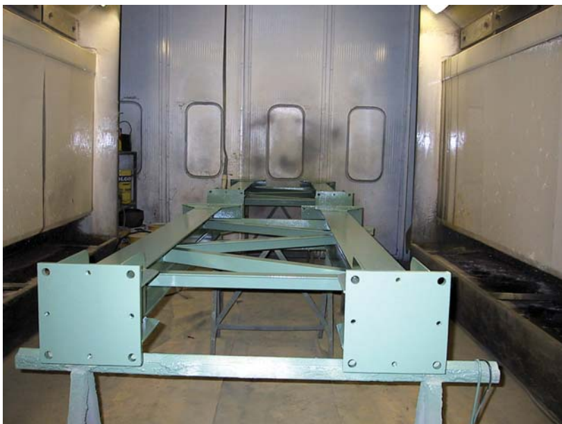
Figura 3 - Cabina di verniciatura a velo d'acqua
