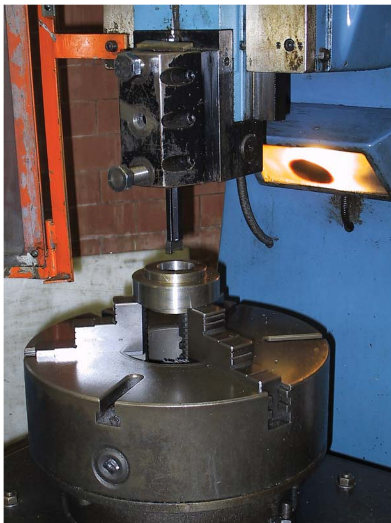
Figura 3 – Operazione di serraggio dell'utensile
