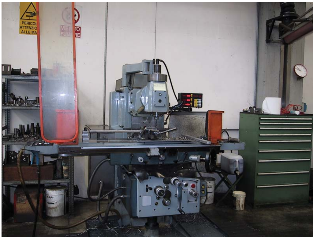
Figura 2 – Macchina con riparo mobile aperto
