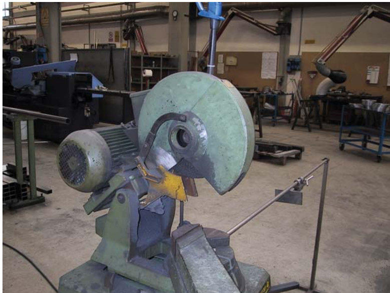
Figura 2 – Troncatrice con carter mobile a leveraggi
