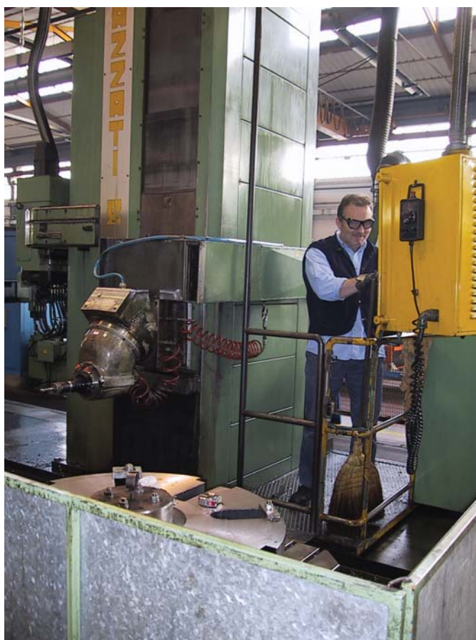
Figura 4 – Posto di lavoro con area segregata
