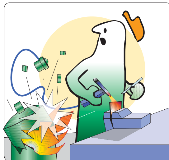
Scoppio delle bombole (pressione massima per l'acetilene 15 kg/m 2 ).
