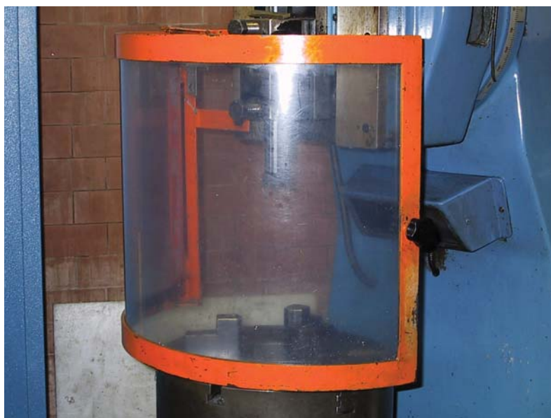
Figura 2 – Riparo mobile con dispositivo di blocco
