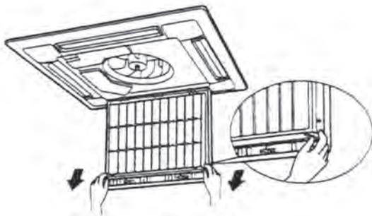
3. Remova a grade de ar de retorno, abra-a a 45° e levante-a conforme mostrado na figura a seguir.
