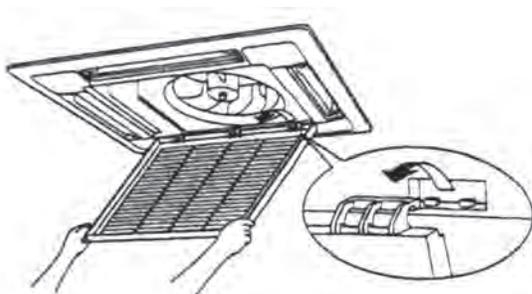
4. Depois de limpá-la, instale a rede do filtro de ar e a rede de retorno do ar. Veja a figura a seguir (de acordo com os métodos apresentados nos passos 1, 2 e 3, realizando a operação em ordem reversa).
