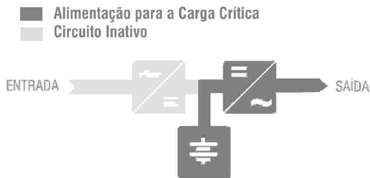
Operação em modo bateria
