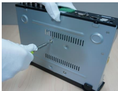
FIG 0-1 CONECTANDO O DISCO RÍGIDO (HD)
