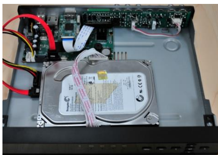
FIG 0-1 CONECTANDO O DISCO RÍGIDO (HD)
