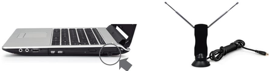
*Nota: Se desejar conectar seu Positivo TV a uma antena externa convencional, você precisará de um adaptador conector MCX macho para conector F fêmea, não incluso no equipamento.*
