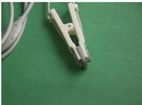
**Figura 14 - Sensor de oximetria orelha acessório de uso permanente) – opcional**
