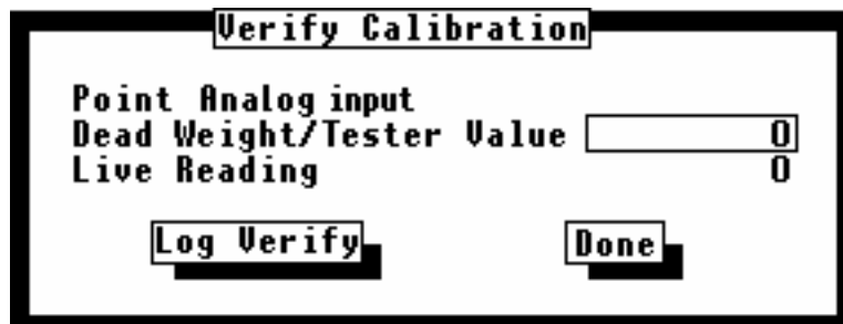
Figure 4-9. Verificação da Calibragem do AI
