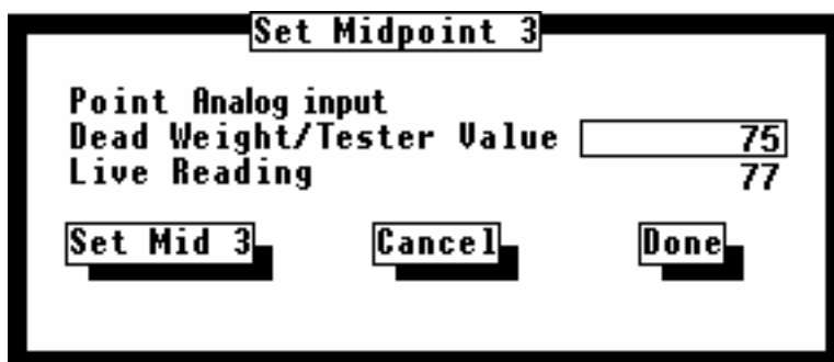
Figura 4-14. Ajuste do Ponto central 3 do AI
