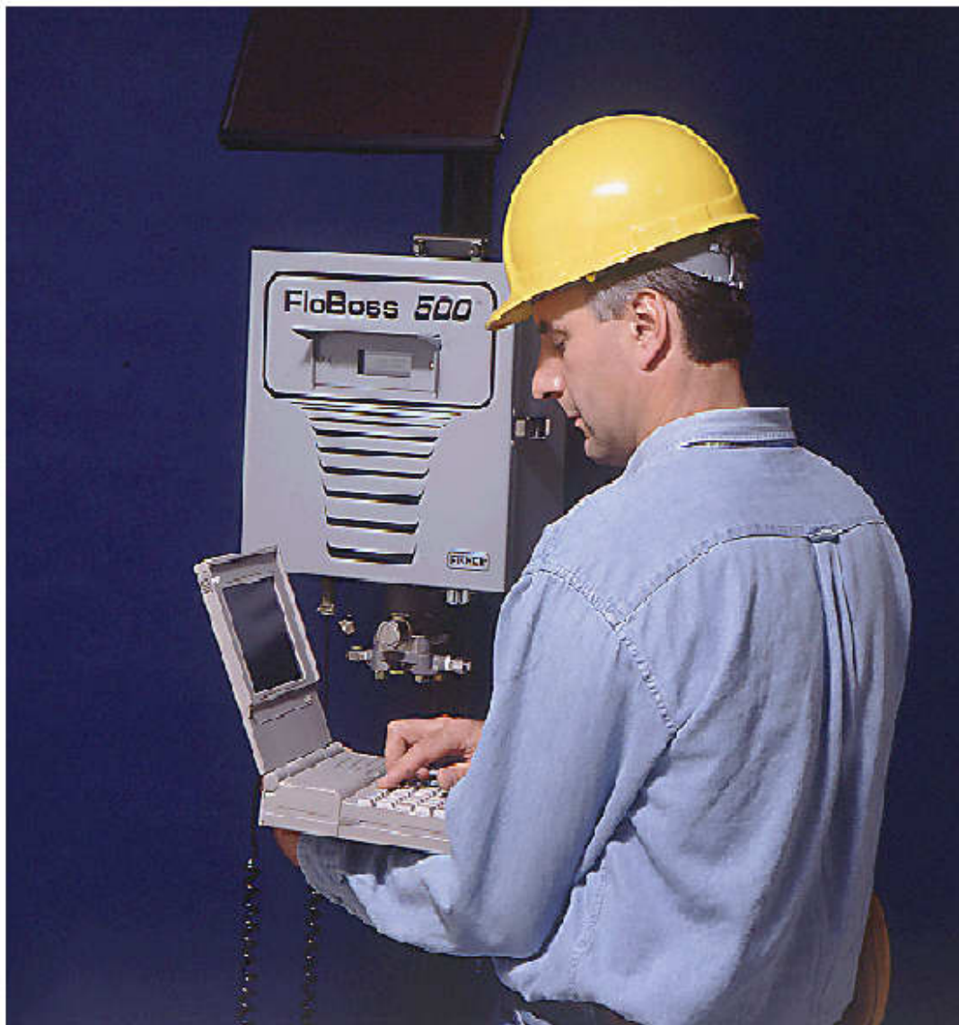
Figura 1-1. Utilizando o Software ROCLINK num Computador Conectado a um FloBoss 503
