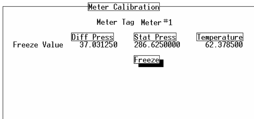
Figura 3-17 Caixa de Diálogo Inicial de Calibragem do Medidor FloBoss 500 (AGA3 mostrado)
