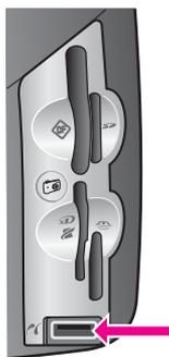
**Nota** Se você inserir o HP bt300 no HP all-in-one e for exibida no visor gráfico colorido a mensagem **No Bluetooth**, desconecte o adaptador do HP all-in-one e consulte **Atualização de dispositivo**.
