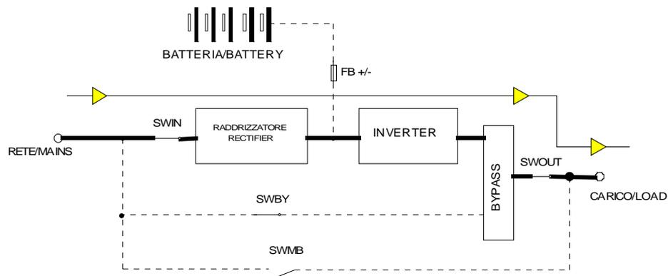
A carga é alimentada pelo módulo inversor que recebe a energia necessária da rede da concessionária alimentada pelo retificador. O retificador carrega a bateria ao mesmo tempo. No painel de controle são acionados os indicadores verdes IN (REDE) e OUT (SAÍDA).
