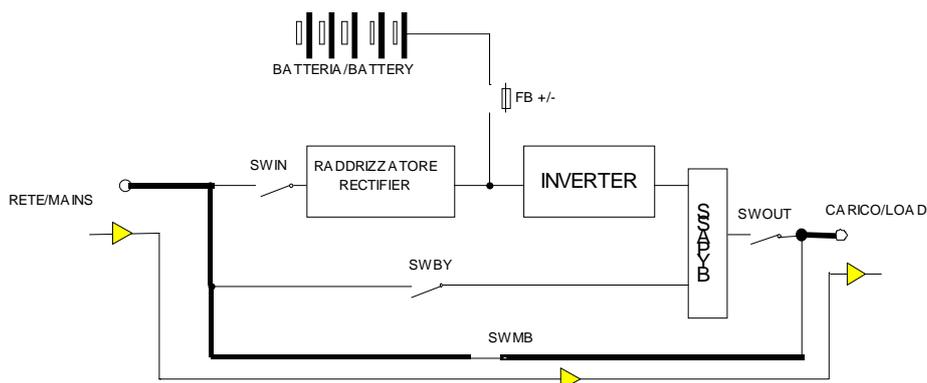
Somente o disjuntor de By Pass Manual SWMB é mantido acionado na posição ON - Liga (através da linha de By Pass de Manutenção) O painel de controle e sinalização estão desligados.
