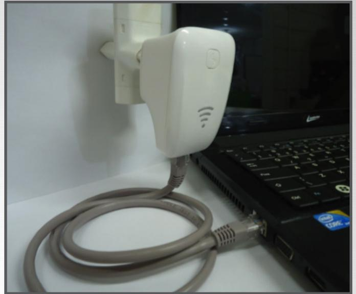
Figura 1 – Conexão Repetidor ao computador
