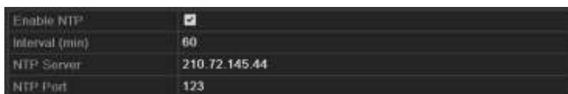
Figura 9.13 Interface de ajustes NTP
