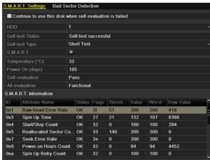
Figura 10. 21 Detecção de setores em mau estado
