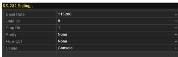
Figure 1. 1 Interface de ajustes da porta RS-232
