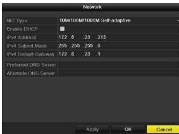
Figura 9.39 Configuração dos parâmetros de rede
