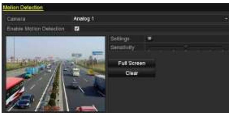
Figura 8. 1 Interface de configuração da detecção de movimento
