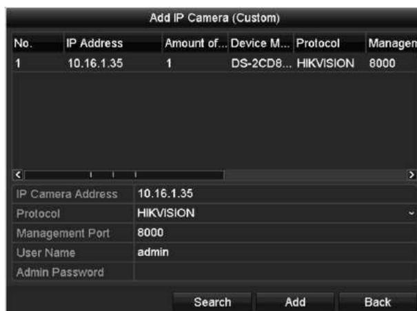
Figura 2. 13 Interface Custom Adding IP Camera (Adição personalizada de câmeras IP)
