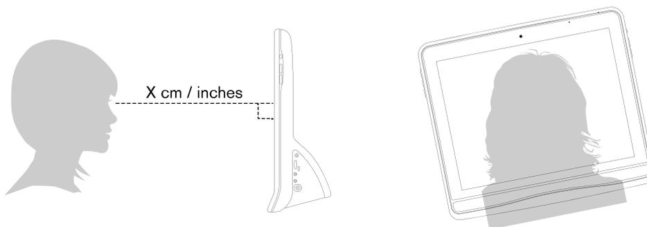
Figura 5.2 Posicionamento para usuários apoiados de lado ou deitados
