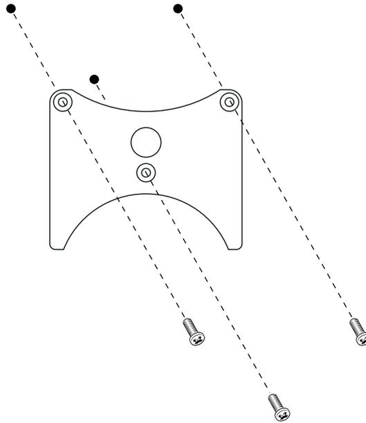
Para montar a placa do adaptador Tobii Dynavox QR:
