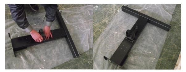
Instale o suporte para o eixo dos rolos da mídia, fixe-os com parafusos Allen.
