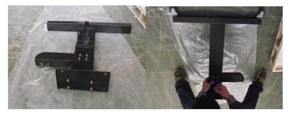
Instale a barra de reforço nos pés da base, usando parafusos Allen.
