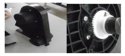
Adicione graxa nos rolos centrais, em ambas as partes do suporte da mídia, depois insira novamente a engrenagem e parafuse. A resistência deve estar menor e seu problema provavelmente será resolvido.
