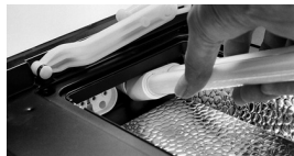
Figura 16: Montagem dos tubos
