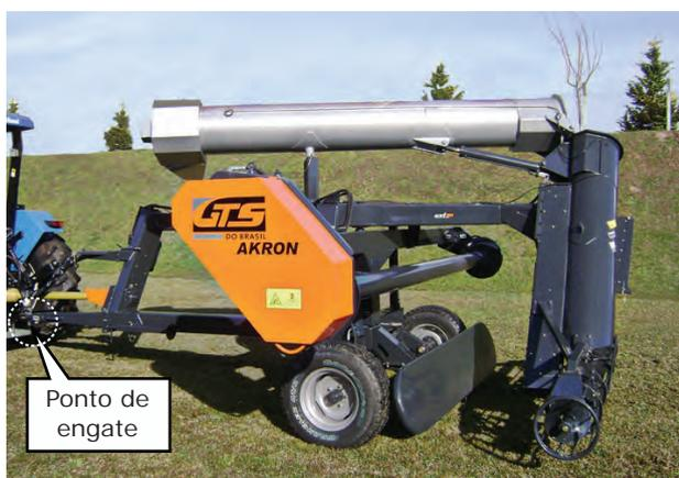
Figura 8.1 – Extratora pronta para o transporte.
