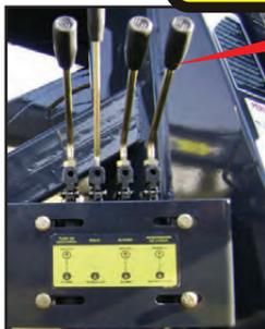
Figura 6.8 - alavanca válvula reguladora em posição “ACELERADOR DE CARGA”.
