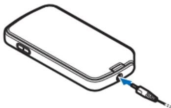
Durante o carregamento, a luz indicadora de carga da bateria ficará vermelha (quando o receptor estiver desligado) ou alternará em verde e vermelho (caso o receptor esteja ligado). Talvez demore algum tempo até o início do carregamento. Se o carregamento não for iniciado, desconecte o carregador e conecte-o novamente.
