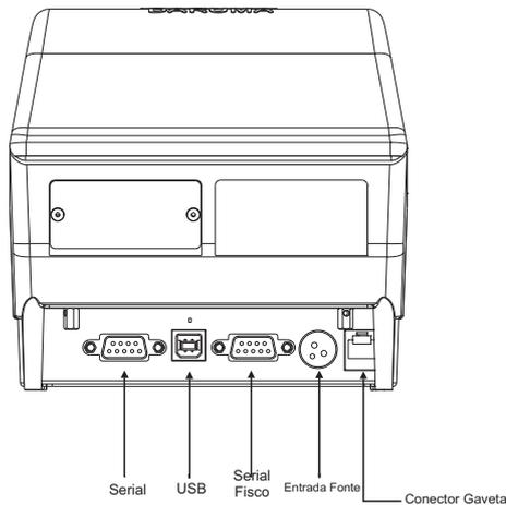
**ATENÇÃO: NÃO LIGUE UMA LINHA TELEFÔNICA AO CONECTOR GAVETA. SE O FIZER, A IMPRESSORA PODERÁ SER DANIFICADA**
