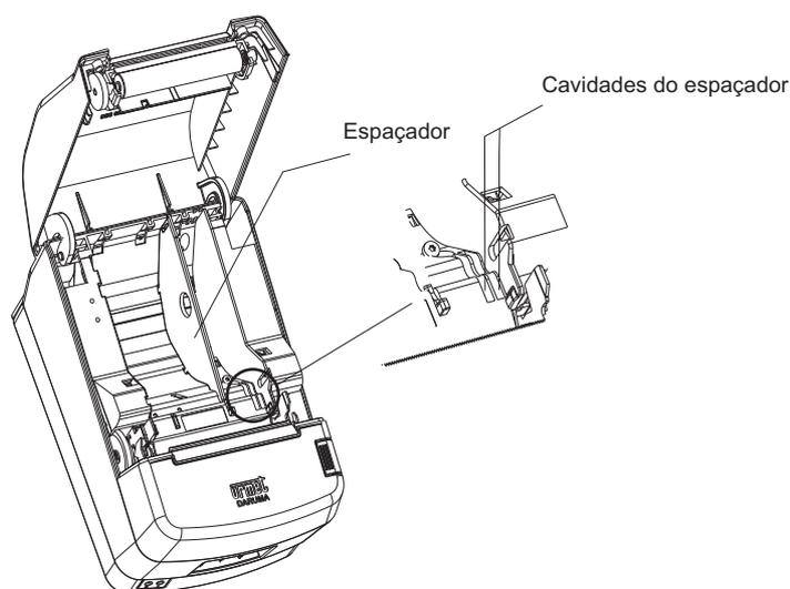
Para operação com bobinas de 76mm e 80mm basta utilizar as cavidades situadas à direita. Se o espaçador não for utilizado, a impressora aceitará bobinas de 82,5mm de largura.
