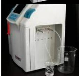
Fig. 25 Coloque os tubos de A/B/WASH na água destilada. Coloque o tubo de resíduos em outro copo. Execute o processo *WASH* para esvaziar.
