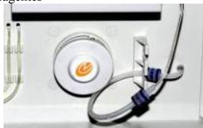
Fig.26 Solte o tubo da bomba.
