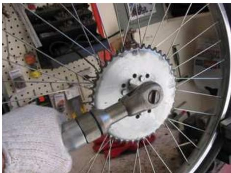
Utilize uma chave de 10mm pelo lado de fora da coroa para apertar os parafusos e outra chave de 10mm pelo lado de dentro para que as porcas não girem em falso.
