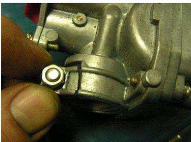
Quando for instalar o carburador conectando-o ao coletor de admissão evite aperto excessivo do parafuso sob o risco de quebrar o carburador inutilizando-o.
