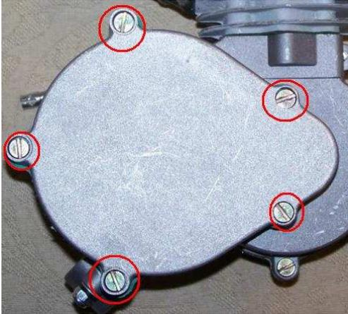
Primeiro retire os cinco parafusos marcados na imagem ao lado com uma chave de fenda.
