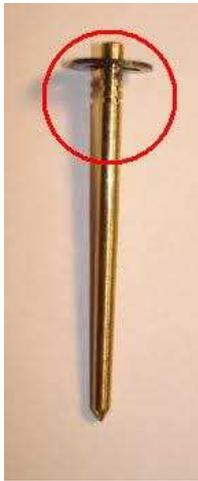
Estes entalhes (4 entalhes nos carburadores mais antigos e 5 nos mais novos) tem por finalidade a regulagem da mistura do carburador, de forma que o clipe em C pode ser retirado e sua posição alterada afim de que a agulha seja levantada (empobrecendo a mistura) ou abaixada (enriquecendo a mistura).
