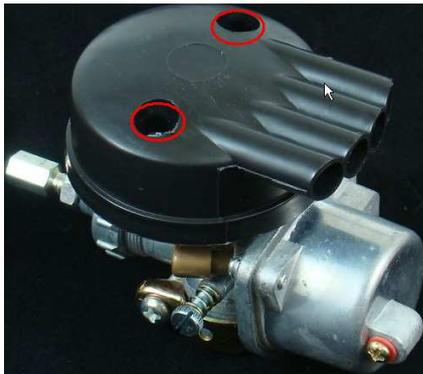
Para ter acesso ao elemento filtrante utilize uma chave Phillips e retire os dois parafusos indicados na imagem ao lado.
