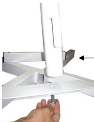
Fixar o mastro ao cavalete com o parafuso e arruelas de 3/8" ( fig) . não apertar o parafuso nesse momento.
