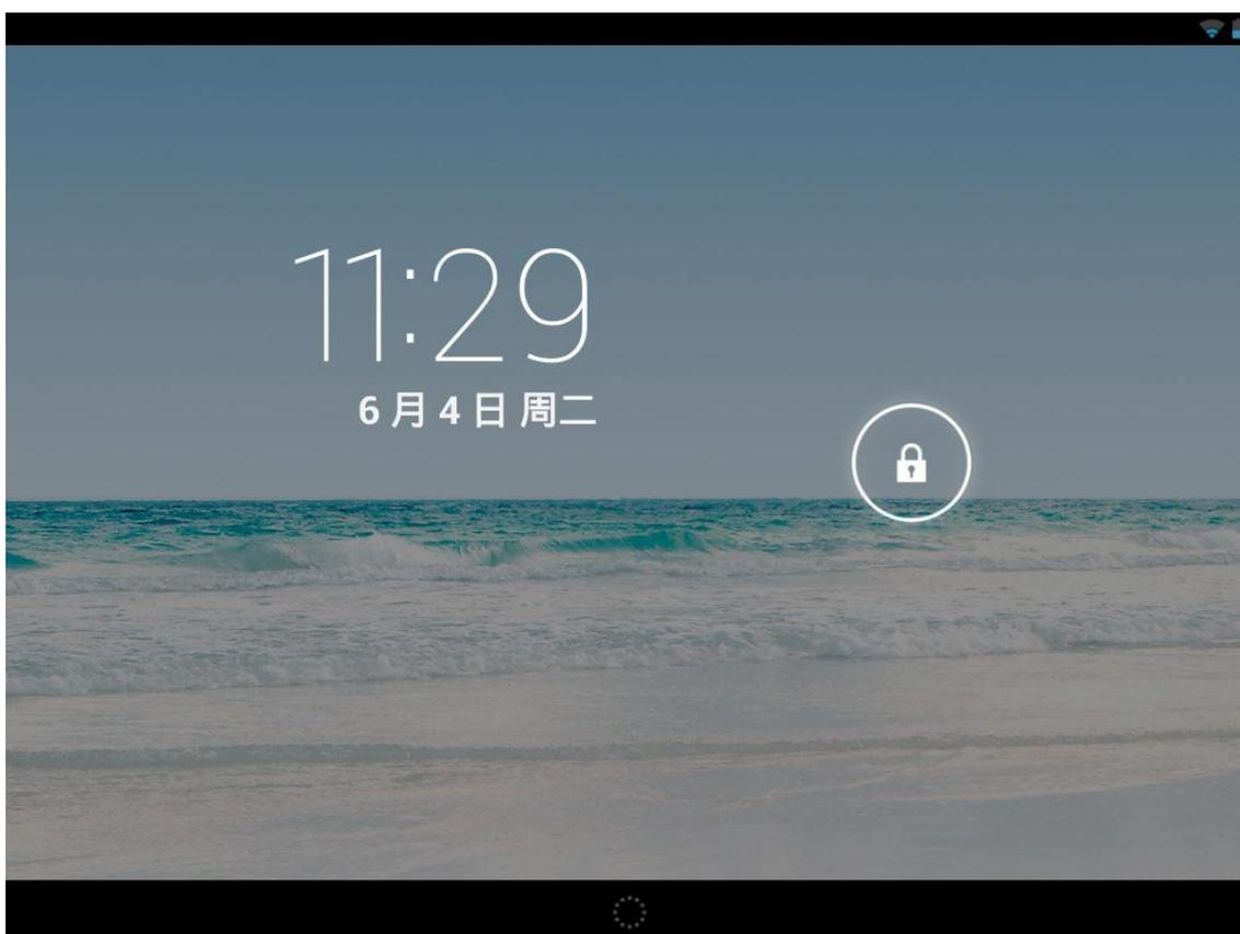
Se o tablet não for usado por um determinado tempo, pressione a tecla Power On e entre no modo Standby. Existem dois modos Standby. Um é o modo dormir, neste momento o ecrã está desligado. Pressione a tecla Power On novamente para entrar no modo sesta, como demonstrado na imagem.
