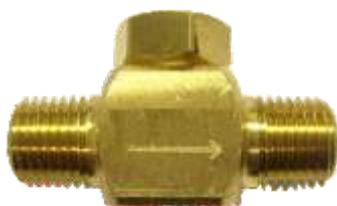
1. Check valve : controla o fluxo de gás comprimido em sistemas que têm atuadores remotos ou uma descarga secundária. Uma seta gravada no lado da válvula indica a direção do fluxo. É essencial verificar à orientação das válvulas de uma via. Se a instalação for invertida, poderá fazer com que o sistema não funcione como deveria. Após o sistema ser descarregado, afrouxe essa conexão para deixar a pressão interna escapar.
