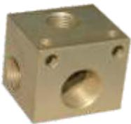
O múltiplo de quatro vias, **PN A523000**, é um bloco quadrado de 2" que conecta o tubo de aço inoxidável ou as mangueiras para distribuição do pó químico seco. O orifício de  $\frac{3}{4}$ " NPT (roscas pra tubo) conecta a linha de distribuição do Extintor às três vias de  $\frac{1}{2}$ " para levar o pó químico aos bocais.
