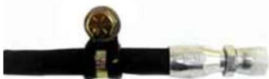
8. Antes de deixar essa parte do sistema verifique as condições da mangueira e conexões. Ajuste as que não estejam firmes. Verifique se o atuador está seguro e se o suporte está montado adequadamente.
