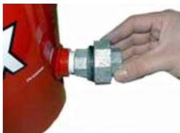
5. Desconecte a porca de união na base do extintor. Remova o disco de ruptura e examine o pó químico seco utilizando uma barra comprida. O pó químico deverá estar seco e consistente.
