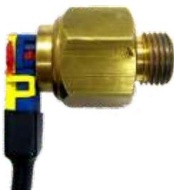
O iniciador, **PN A709500**, é um dispositivo explosivo capaz de produzir pressão de gás ao ser ativado por uma carga elétrica. O lado que tem o selo metálico deverá ser aparafusado no mecanismo disparador. O outro lado tem dois terminais e se junta o chicote do iniciador. O iniciador tem prazo de validade de cinco anos (5) anos. O iniciador tem sua data de fabricação escrita em um dos lados em que se aperta com uma chave.
