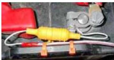
O Equipamento de detecção AFEX fica conectado à bateria do veículo para proporcionar 24h de proteção. O sistema AFEX funciona em 12 ou 24 volts, corrente contínua. O equipamento de detecção é formado por uma série de sensores, o iniciador, o chicote elétrico e o cabo elétrico. Os sensores são conectados em paralelo, utilizando-se o cabo elétrico da AFEX. O projeto do Equipamento de detecção se encontra no manual de instalação, operação, manutenção e serviço.
