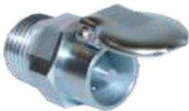
O bocal, **PN A551000**, foi projetado especificamente para o ambiente abusivo de equipamentos pesados. A tampa mecânica usa uma mola para manter o bocal limpo. Ao descarregar o sistema, a pressão abre a tampa e empurra o pó químico seco do bocal no formato de um cone.
