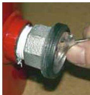
6. Limpe as roscas da porca de união e instale um novo disco de ruptura. A arruela de "milar" deverá estar voltada para fora do extintor. Aperte a porca de união para selar o extintor contra umidade e resíduos.
