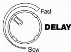
As funções de intervalo devem ser usadas para ajustar o intervalo de troca de escuro para claro no filtro de soldagem de acordo com o método e a corrente.
