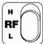
Novo interruptor de RF Alta/Baixa para um melhor controle de sensibilidade. Mude para alta em amperagens extremamente baixas com solda TIG (abaixo de 1 amp) ou quando usando cabos e soldadores blindados. Mude para baixa quando trabalhando perto de outros soldadores ou em áreas com interferências altas de RF para evitar falsos disparos e para uso geral.
