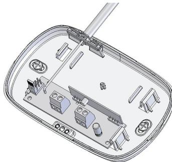
A figura anterior mostra o receptor XAR 2000 (opcional). Use-o quando houver a necessidade de instalação de sensores sem fio ou controles remoto. A ligação deve ser feita com cabo 4X26 AWG ou superior, com comprimento máximo de 100 m e resistência
