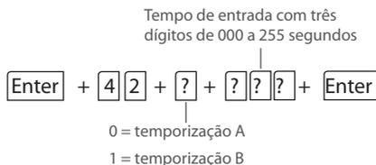
1. Se a central não estiver em modo de programação, proceda conforme descrito em *Entrar no modo de programação*, utilizando a senha do instalador;
