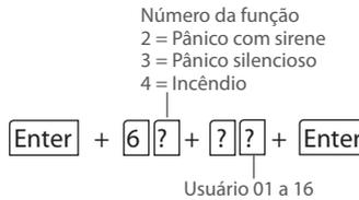
1. Se a central não estiver em modo de programação, proceda conforme descrito em *Entrar no modo de programação*, utilizando a senha do instalador;
