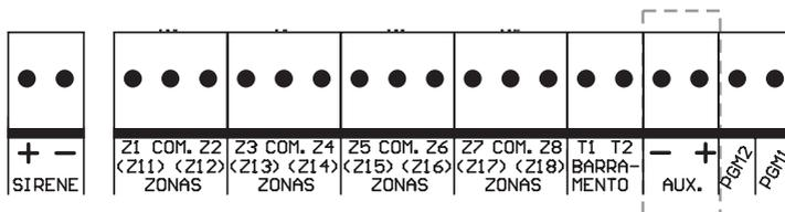
Esta saída é utilizada para alimentar acessórios tais como, interface para cerca elétrica, sensores de infravermelho, teclado remoto, etc.
