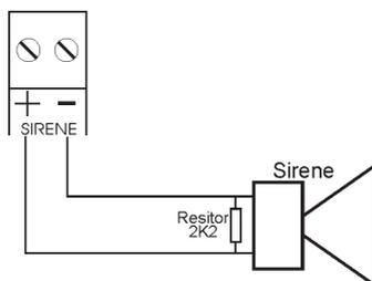
Para que a central de alarme reconheça o corte ou curto-circuito do fio da sirene é necessário ativar esta função no modo de programação.
