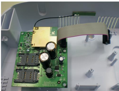
5. Retire a proteção do adesivo na parte posterior da antena e fixe-a na parte interna do gabinete próximo as aberturas de ventilação superiores, conforme a figura a seguir:
