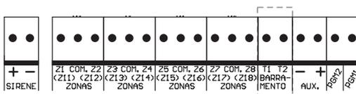
Este borne é o barramento digital utilizado para controlar os teclados e receptores de dispositivos sem fio.
