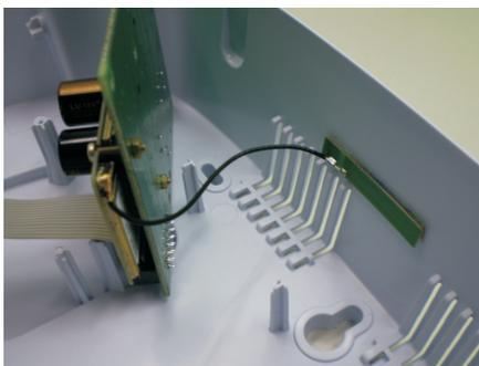
4. Encaixe a placa expansora GPRS no gabinete e fixe-a com os parafusos;
