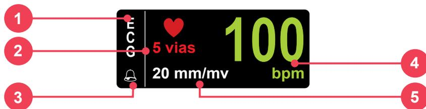
**1** - Símbolo de ECG. O ícone de ECG representa um coração que se expande indicando a detecção do pico da onda R do ECG.
