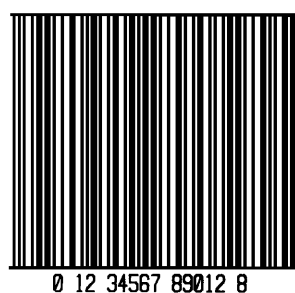
Código de Barras L Intercalado 2 de 5 com checksum módulo 10 e barras de proteção
