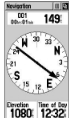
Página de Navegação com o Ponteiro de Rumo mostrando a direção a seguir. A bússola fornece orientação.
