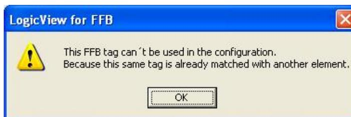
**Fig 3. 215 – Erro ao mudar um tag dos parâmetros FFB**
