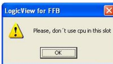
**Fig 3. 172 – Erro - Inserção de CPU em slot errado**
