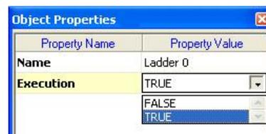
**Fig 3. 208 – Definindo a execução dos diagramas ladder**
