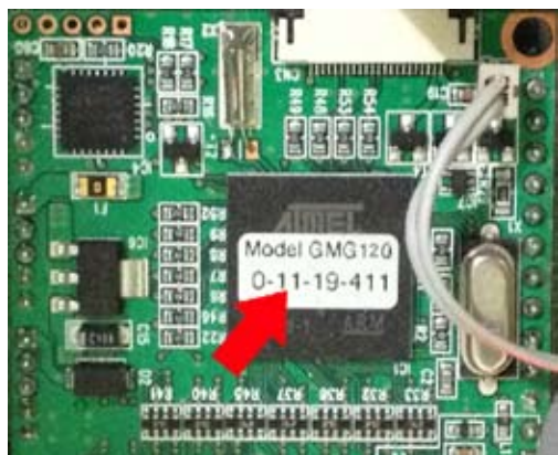
Figs. 28 e 29: Verifique a numeração contida na etiqueta do módulo de controle GMG 120 na placa PC2. A numeração deverá estar presente na lista de dispositivos da tela principal do NKHM.
