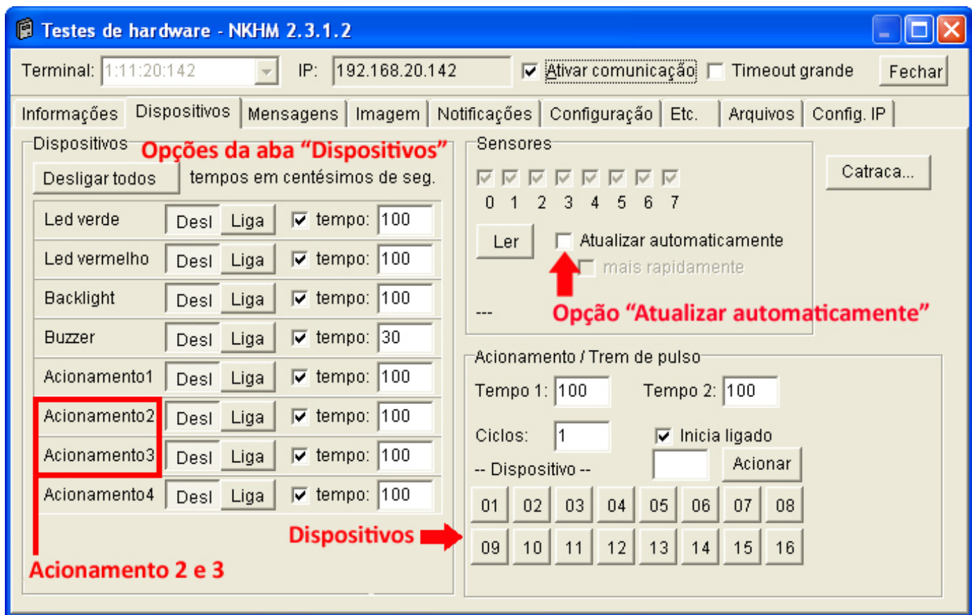
Fig. 45 - As opções da aba "Dispositivos" permitem a execução de testes na PC2 e no GIO 110
