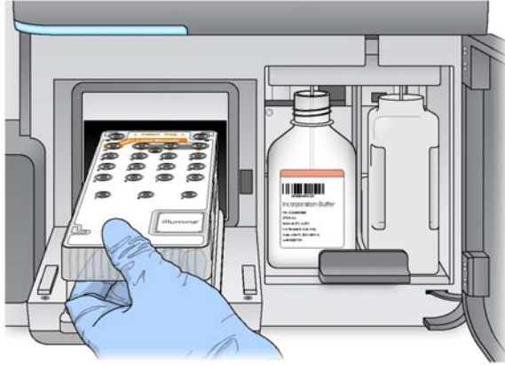
Figura 22 Carregamento do cartucho de reagentes
