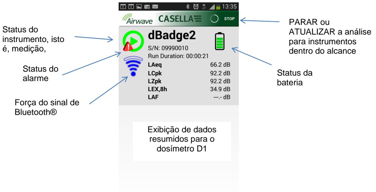
Para economizar energia, o aplicativo Airwave interrompe a busca assim que todos os instrumentos dentro do alcance tiverem sido detectados. Para buscar novos instrumentos, pressione “ATUALIZAR” no canto superior direito do display do dispositivo móvel.
