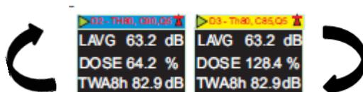
D1 é o dosímetro padrão que relata os valores de doses selecionados, bem como outros parâmetros de ruídos (pico, máx, etc.) D2 e D3 oferecem opções adicionais. A barra de cabeçalho para medições do D1 é a cor da tela de fundo. O D2 possui uma barra de cabeçalho azul o e D3 uma barra de cabeçalho amarela.
