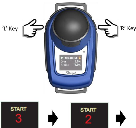
As teclas devem permanecer pressionadas durante a contagem regressiva para que a medição seja iniciada; soltar as teclas durante a contagem regressiva 3-2-1 encerrará a operação.
