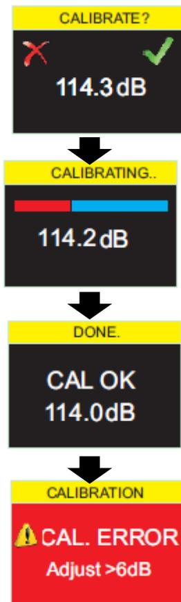
Pressione a tecla direita “R” para confirmar a calibração ou a tecla esquerda “L” para cancelar a operação. Levará alguns segundos para calibrar automaticamente para 114 dB. Uma barra de progresso será exibida durante este tempo, como mostrado.
