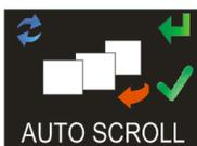
Se selecionado, o display rolará automaticamente de uma tela para a próxima (caso contrário, a tela precisará ser avançada manualmente). Pressione a tecla direita “R” para aceitar ou tecla esquerda “L” para alterar
