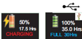
O tempo para carregar a bateria completamente é de aproximadamente 6 horas, o que permitirá o funcionamento por cerca de 35 horas. Observe que este tempo não considera a gravação de áudio ou a análise de faixa oitava, além de presumir que o display seja mantido desligado durante 95% do tempo.
