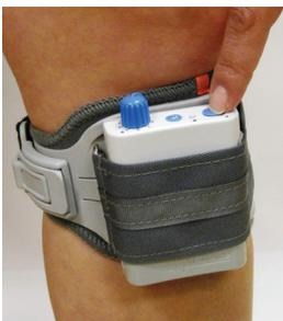
**Figura 6: Testar a estimulação e colocação adequada do WalkAide**
