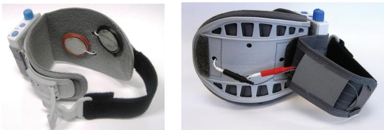
**Figuras 9 e 10: Substituir os eletrodos (visões interior e exterior)**
