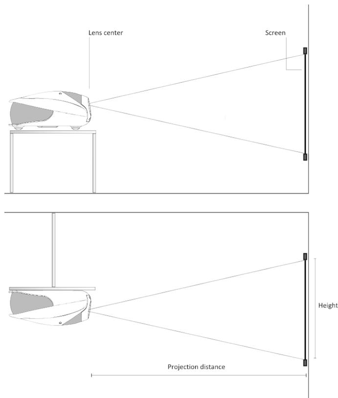
Se não for possível posicionar o projetor perpendicularmente à tela de projeção (para que o centro da lente e o centro da tela estejam alinhados uns com os outros), você pode usar o controle mecânico da lente na parte superior do projetor para mudar a imagem projectada na vertical:
