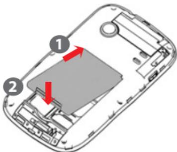
1. Coloque os pontos de contato de metal da bateria voltados para cima e alinhe-os com os pontos de contato de metal do encaixe da bateria; em seguida, insira a parte inferior da bateria no encaixe.
