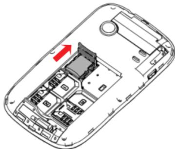
Desligue o telefone; remova a bateria e outras conexões de energia externas.
