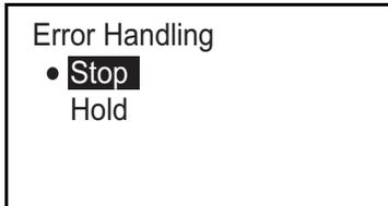
Selecione Hold (Em espera) ou Stop (Parar). Hold direciona o medidor, em caso de um erro de medição da vazão, para manter o envio dos pulso enviados na última leitura sem erros. Stop direciona o medidor, em caso de erro de medição, para parar de pulsar.
