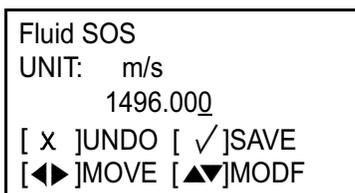
Use a tecla de seta [◀] ou [▶] para selecionar o dígito a ser alterado, use as teclas de seta [▲] ou [▼] para alterar a definição de SOS de fluido e pressione [√] para retornar à tela anterior. Em seguida, pressione [x] para retornar à tela Sensor Setup (Configuração do Sensor).
