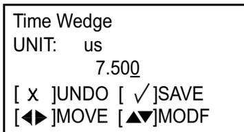
Use a tecla de seta [◀] ou [▶] para selecionar o dígito a ser alterado, use as teclas de seta [△] ou [▽] para alterar a definição de cunha do tempo e pressione [√] para retornar à tela anterior. Em seguida, pressione [✕] para retornar à tela Transducer (Transdutor).
