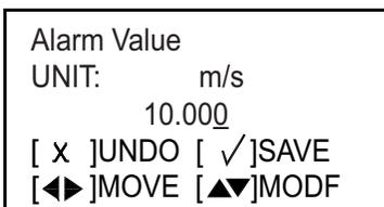
Para alterar o Valor do Alarme, use a tecla de seta [◀] ou [▶] para selecionar o dígito a ser alterado, use as teclas de seta [△] ou [▽] para fornecer um novo número e pressione [√] para salvar. Pressione [√] para retornar ao menu Alarm (Alarme).
