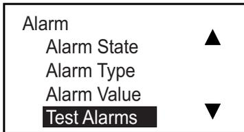
Para testar a saída de alarmes, selecione Test Alarms (Testar alarmes) e pressione [√]. A tela a seguir é exibida.
