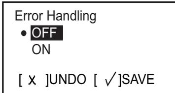
Selecione OFF para desligar o alarme ou ON para ligá-lo. Para iniciar o teste, selecione ON e pressione [√]. Para interromper o teste, pressione [×].
