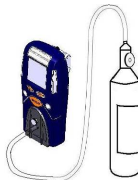
Figura 4.1 Configuração de Teste de sensores / calibração com gás
