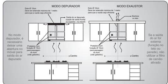
NOTA: Para fixação, centralizar o fogão com o depurador. Com uma trena, achar a altura entre o fogão e a base do depurador, conforme indicado neste manual (65 a 80 cm). O duto deve ser utilizado tanto no modo exaustor quanto no modo depurador e não deve ultrapassar 1 metro até a saída externa, para que a vazão de ar seja eficiente.
