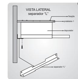
D) Caso seja necessário acabamento, utilizar o separador "L". O separador permite acabamento de duas formas (distâncias), dependendo do lado que é utilizado.
