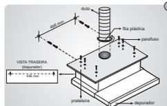
C) Fixar o depurador na prateleira com os parafusos e arnelas do kit de fixação e encaixar o duto na conexão fixando-o com a fita plástica. Caso seja necessário, fixar o depurador pelo fundo, utilizando as buchas e parafusos. Nunca fixar somente pelo fundo, a fixação superior deve ser sempre providenciada.
