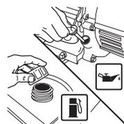
**MISE EN GARDE** Ne jamais remplir le réservoir à carburant jusqu'au bout. Remplir le réservoir jusqu'à 1/2 po sous la base du col de remplissage afin de permettre l'expansion du carburant. Essuyer tout carburant versé sur le moteur ou sur l'équipement avant de démarrer le moteur.
