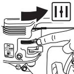
**IMPORTANTE:** Dejar que el generador funcione por unos 5 minutos sin carga cada vez que se arranque para que el motor y el generador se estabilicen.
