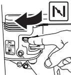
la commande d'étranglement est en position 'RUN' pour démarrer un moteur chaud.
