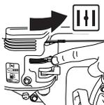
5. Une fois le moteur en marche, déplacer graduellement la commande d'étranglement vers la position 'RUN'.
