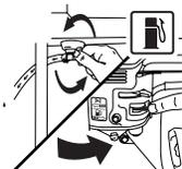
**NOTA:** Cuando el motor esté tibio no se necesita activar el choke. Cerciorarse que la palanquita del "CHOKE" esté en la posición de "RUN" (Operación).
