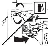
1. Ouvrir la soupape de coupure de carburant.
