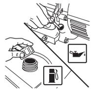
**⚠ PRECAUCIÓN:** Nunca llenar el tanque de combustible completamente. Sólo llenar el tanque hasta 13mm (1/2") por debajo de la parte inferior del cuello de la toma para permitir la expansión del combustible. Limpiar cualquier derrame de combustible del motor o del equipo antes de arrancar el motor.
