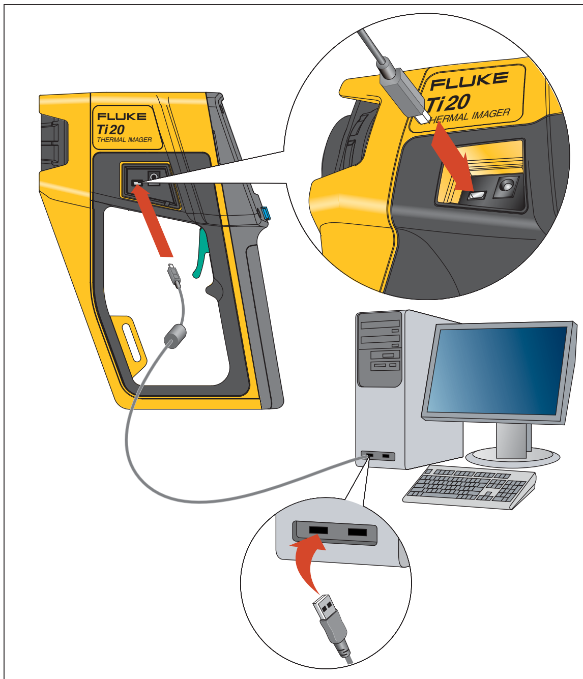
Figura 1-9. Conexão com o cabo USB
