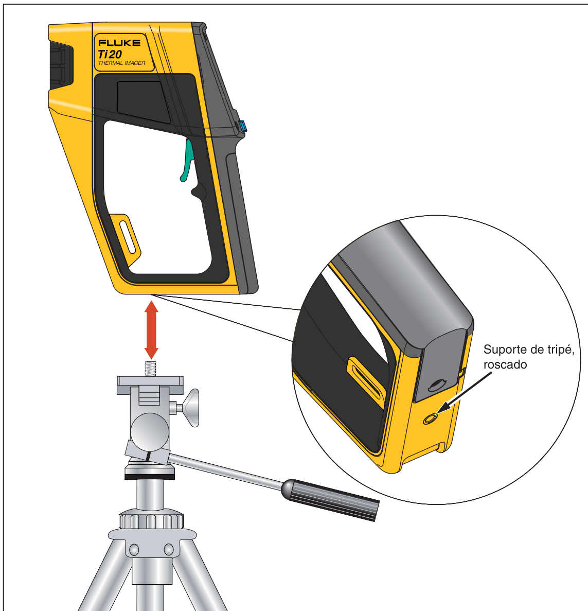
Figura 1-10. Montagem do termovisor no tripé
