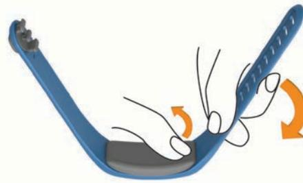
2 Insira o dispositivo na lateral esquerda do prendedor de silicone flexível ao esticar o material do prendedor em torno do dispositivo.
